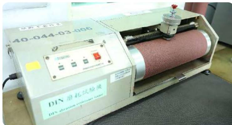
圖示 | 磨耗測試機
