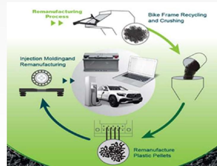
圖示 | 熱塑碳纖維產品回收再利用製程
