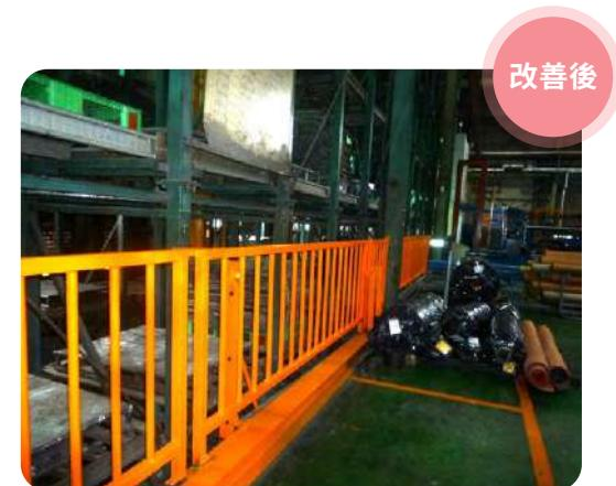
圖示 | 改善後：改設置鋼性護柵
